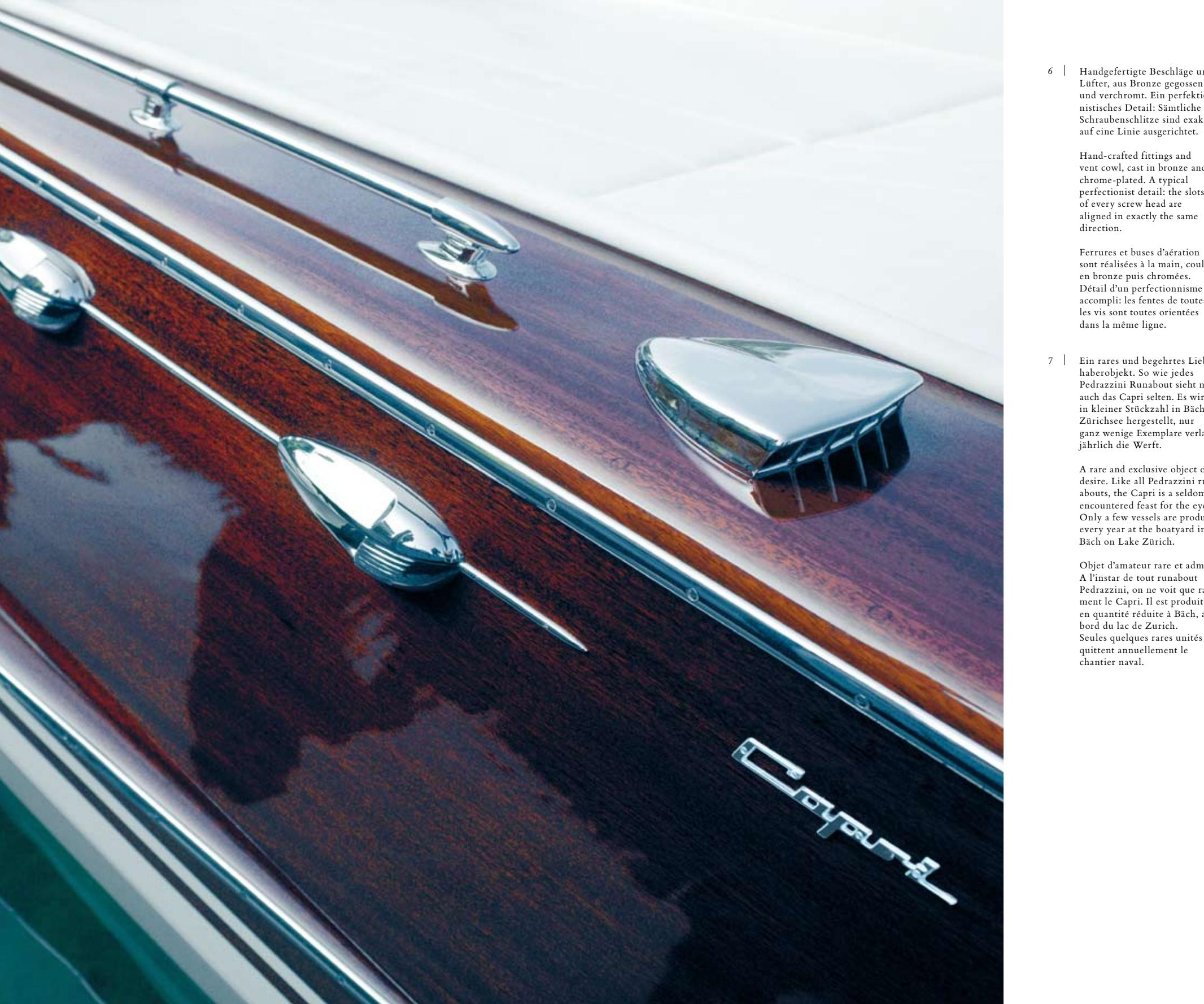
6 | Handgefertigte Beschläge und Lüfter, aus Bronze gegossen und verchromt. Ein perfektionistisches Detail: Sämtliche Schraubenschlitzes sind exakt auf eine Linie ausgerichtet.
